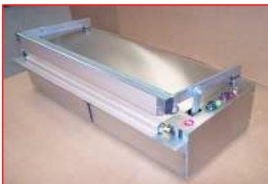
La saldatrice PN esegue una saldatura ad impulso per mezzo di due resistenze, una su ciascuna barra. Il funzionamento ad aria compressa garantisce una forte ed uniforme pressione su tutta la lunghezza di saldatura.
