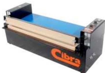
La saldatrice PN è una testata saldante di grande potenza, indicata per sigillare sacchi di polietilene, PVC, polipropilene di forte spessore, e anche sacchi in alcuni tipi di accoppiati e coestrusi. Disponibile in versione verniciata e in acciaio inox; può lavorare posta su un tavolo, oppure montata su un supporto verticale; può avere barre saldanti di varie lunghezze e con diverse larghezze e impronte di saldatura.
